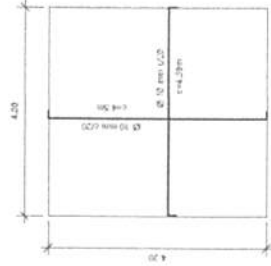
4 Detalhamento da laje de transição - armadura positiva 1:50
