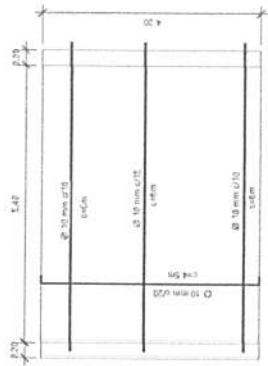
3 Armadura positiva longitudinal e transversal 1:50
