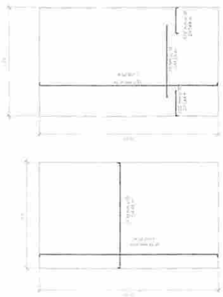
4. Armadura posicao longitudinal e transversal
