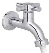
Torneira de parede para tanque e jardim, com adaptador para mangueira, acionamento de ½ de volta, acabamento cromado. A ser instaladas no DML, abrigo de lixo, solarium e áreas verdes.
